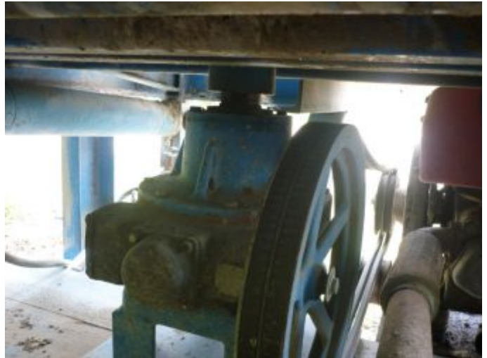
A betonkeverő alatt elhelyezkedő áttételszekrény
